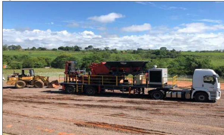
Figura 101 - Usina de beneficiamento de RCC em Presidente Prudente.
