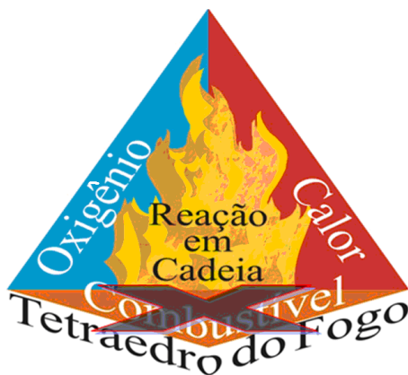
Figura 17 - Retirada do material combustível Fonte: 9ºGB - CBPMESP
