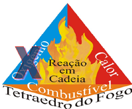
Figura 18 - Retirada do oxigênio Fonte: 9ºGB - CBPMESP
