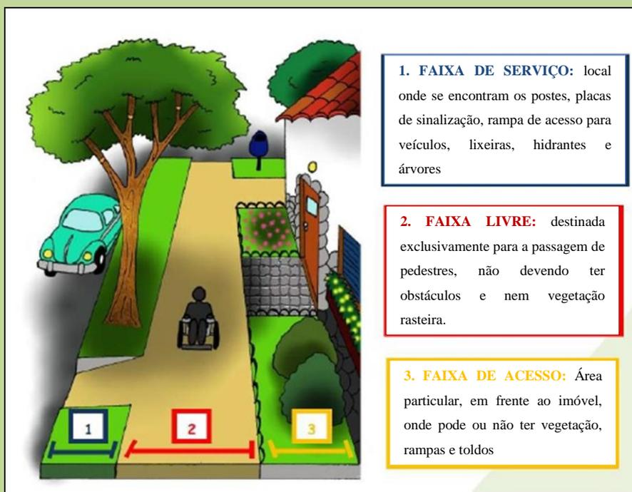
Figura 6 – Ilustração de uma Calçada Ecológica
